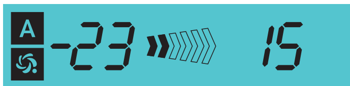
Рисунок 5.4 — Вид ЖК-дисплея, когда прибор соединен с базовой станцией системы MagicAir и находится под ее автоматическим управлением
