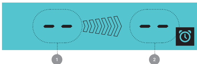
Рисунок 5.12 – Индикация режима «Ожидание» на ЖК-дисплее при активном таймере
