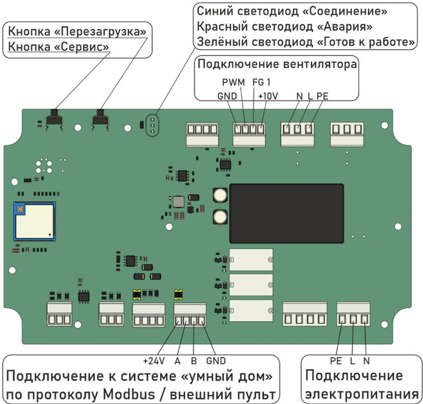
Рис. 3 Схема подключения
